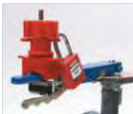
Verriegeln von Drosselventilen mit der Universal-Ventilabspernung: Der Haken wird am Griff des Drosselventils angebracht, damit der Griff nicht mehr betätigt werden kann. Die Ventilstellung kann nicht mehr verändert werden.
