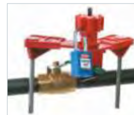
Zwei Blockierarme zum Absperrn von 3-, 4- oder 5 Wege-Ventilen oder zum Absperrn von Ventilen in halbgeöffneter Stellung zur Überwachung von laufenden Anlagen.
